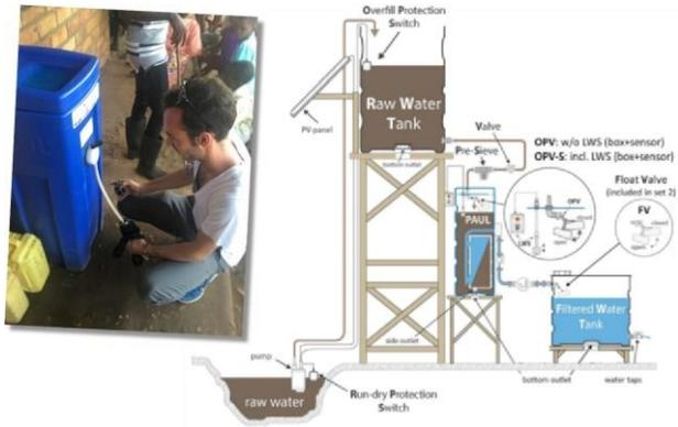
Aktuell wird der Wasserfilter PAUL von Hand befüllt und stellt sauberes Trinkwasser ausschließlich zum Trinken zur Verfügung. Mit dem konkreten Projekt wird PAUL zukünftig **durch einen Wasserturm** inkl. Pumpen ergänzt, um für die Versorgung von wichtigen Bereichen der Schule, z.B. Duschen, WCs und Küche in Tanks **ausreichend Wasser** zu speichern.
